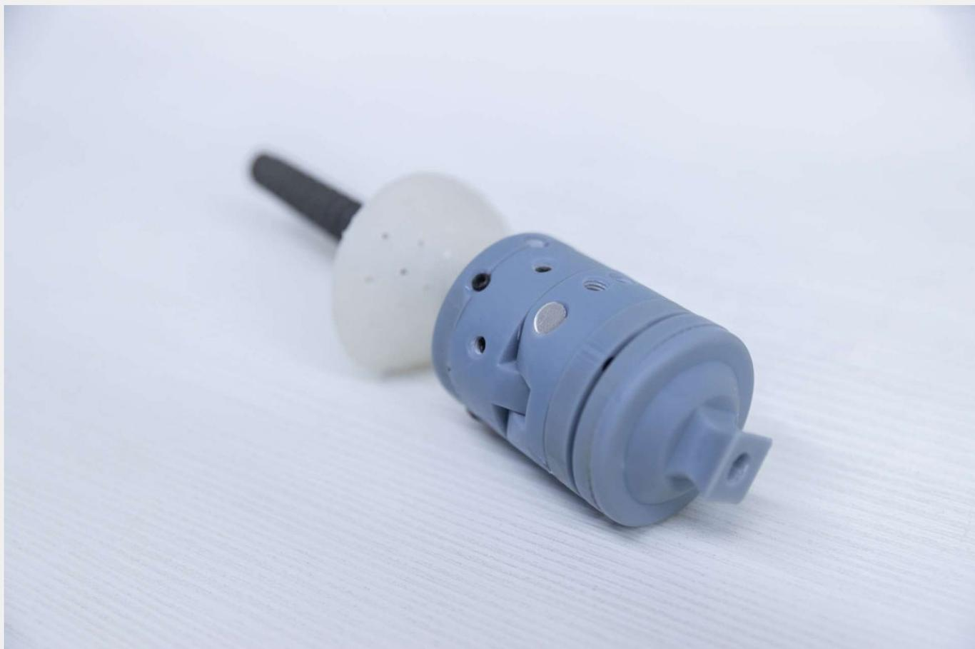
Главное отличие нового протеза от импортных аналогов – в переходнике, амортизирующем ходьбу. Сейчас инженеры работают над созданием части протеза, которая примет импульсы от шагов на себя. Это позволит сделать протез максимально комфортным для пациентов, но не только. Такая система защитит вживленный в кость имплант от разрушения в случае падения. И это – только первый шаг, уверена команда разработчиков.
