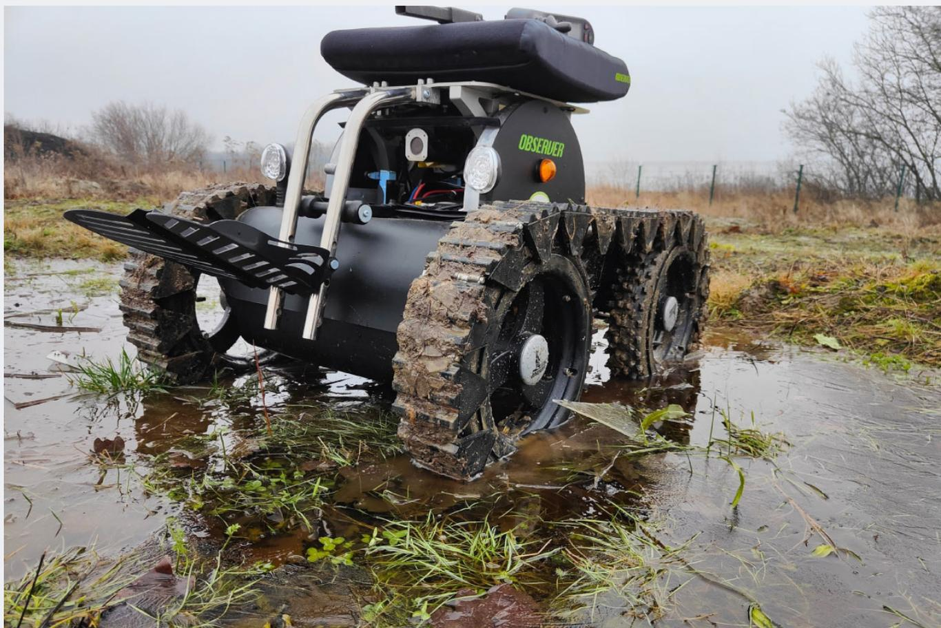
Инженеры команды Polytech Voltage Machine при поддержке Высшей школы транспорта Института машиностроения, материалов и транспорта разработали прочную и быстросъемную гусеницу для инвалидной коляски. Устройство позволяет людям с ограниченными возможностями передвигаться по сложным поверхностям, таким как песчаные пляжи, лесные тропы и заснеженные дороги.
