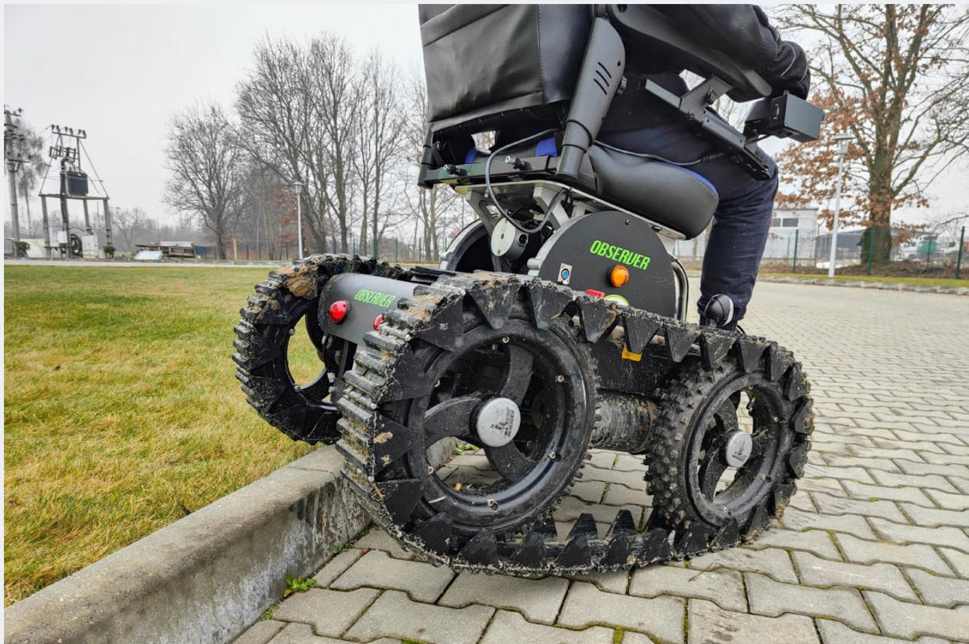
Перед передачей изделия заказчику команда провела полномасштабные испытания в реальных условиях эксплуатации. Оператор расположился в коляске и, управляя джойстиком, преодолел сложнейший маршрут. Коляска уверенно прошла через пересечённую местность, включая заболоченные участки, распутицу и разноуровневые участки дорог.
