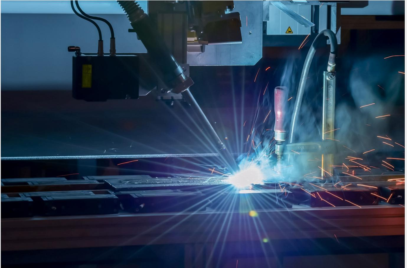
Инженеры Лаборатории легких материалов и конструкций Института машиностроения, материалов и транспорты разработали технологию электродугового выращивания, которая позволяет использовать металлическую проволоку вместо порошка для создания различных изделий. Данная технология способна значительно снизить стоимость аддитивного производства, а для изделий с простой геометрией конкурирует с токарно-фрезерным производством. Исследования ведутся в рамках нацпроекта «Наука».
