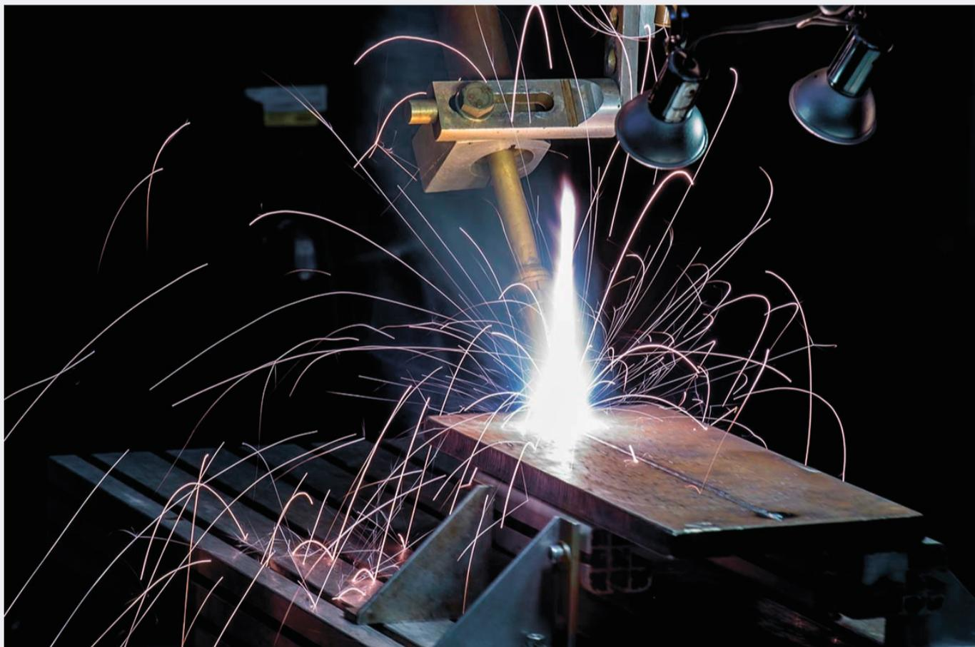
Ученые ИММиТ определили, как защитные противокоррозионные покрытия влияют на процесс электродуговой сварки. Оказалось, покрытия, включающие в себя кислород, негативно сказываются на стабильности горения электрической дуги. Результаты исследования опубликованы в журнале “Coatings”.
