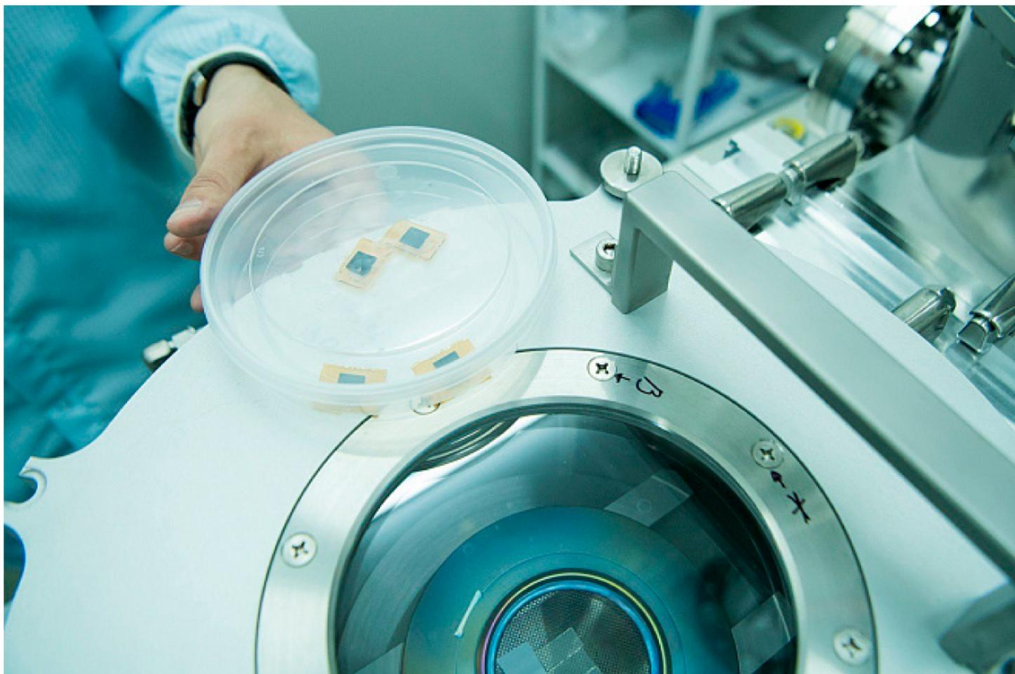
Ученые Высшей школы физики и технологий материалов разработали метод выращивания на подложках массивов углеродных нанотрубок с использованием слоев оксида никеля контролируемой толщины.
