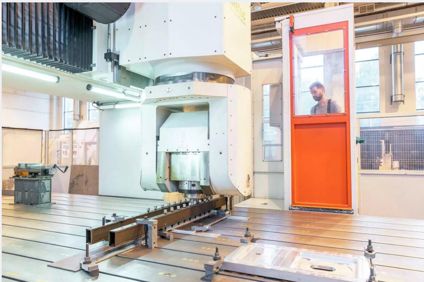
Также ученый отметил, что толстый алюминиевый лист экономически более выгодно сваривать именно таким способом, так как при дуговой сварке с материалом нужно проводить ряд дополнительных манипуляций (например, дуговая сварка проводится в несколько проходов, чтобы заполнить всю толщину шва присадочным материалом). Кроме того, СТП – зеленая технология, при ее использовании не происходит выделений аэрозолей, свечения!
