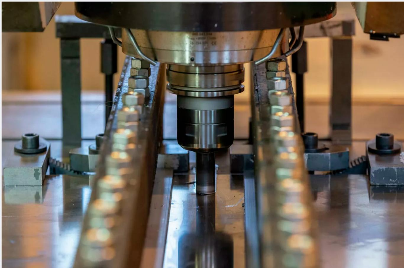
Ученые Института машиностроения, материалов и транспорта впервые в России разработали технологию сварки трением с перемешиванием (СТП) нового алюминиевого сплава для легкого пешеходного моста. Реализовывать инновационную научную разработку инженеры намерены на базе вуза: они планируют сварить элементы, а затем на месте постройки объекта соединить их в мост.
