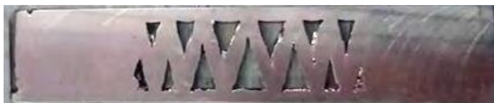
Рисунок 5. Образец с градиентной плотностью, полученный методом ГПЛВ. Материал Inconel 625
