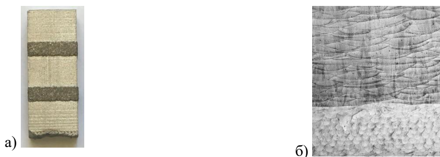
Рисунок 1. Образец с градиентной структурой, полученный методом СЛП. Материал Inconel 625, где а – внешний вид образца, б – микроструктура полученная на оптическом микроскопе, где сверху – пятно 800 мкм, снизу – 83 мкм
