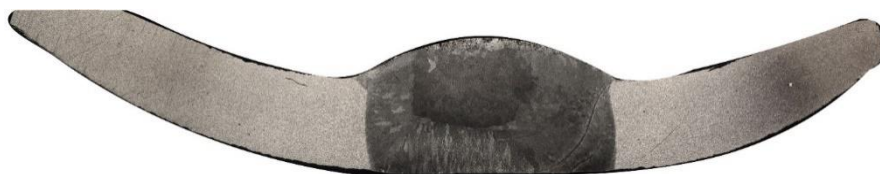
Рисунок 1. Шлиф продольного сечения шва, выполненного при 20А
