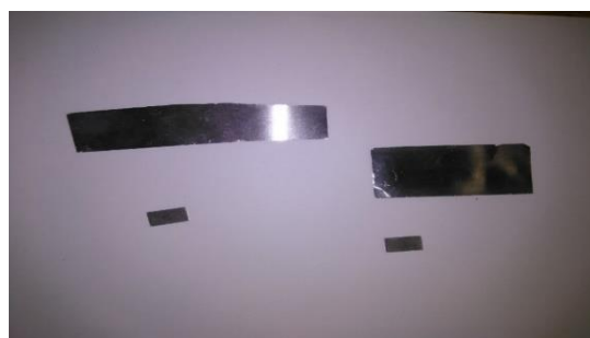
Рисунок 2 Результаты прокатки образцов
