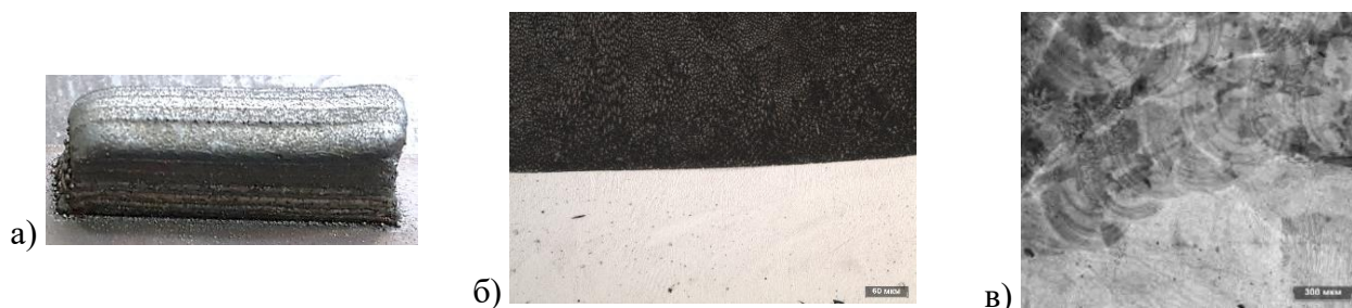
Рисунок 4. Образец с градиентными свойствами, полученный методом ГПЛВ, где а – пример внешнего вида образцов, б – микроструктура, в которой Inconel 625 (сверху) и AISI 316L (снизу), в – микроструктура наплавки Inconel 625 широким диаметром лазерного пятна (сверху) и малым диаметром лазерного пятна (снизу)
