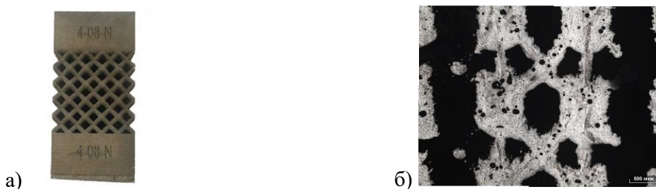
Рисунок 3. Образец с градиентной плотностью из сплава ВТ6, полученный методом СЛП, где а – образец, б – микроструктура сетки на оптическом микроскопе
