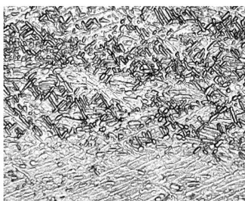
Рисунок 2. Микроструктура листа  $t = 5$ мм из сплава BT23 после закалки (  $\times 500$ )
