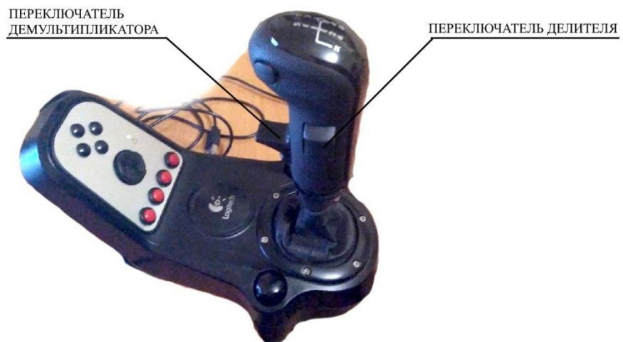
Рисунок2. Рычаг коробки передач LogitechG27, имитирующий рычаг коробки передач грузового автомобиляMANTGS/TGX (фото Васильева А.И.)
