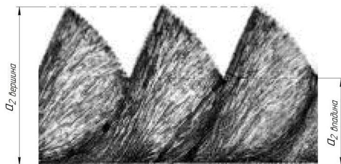
Рисунок 2. Схема к определению толщины суставчатой стружки по вершинам  $a_2_{\text{верш}}$  и впадинам  $a_2_{\text{впад}}$  сформированных элементов
