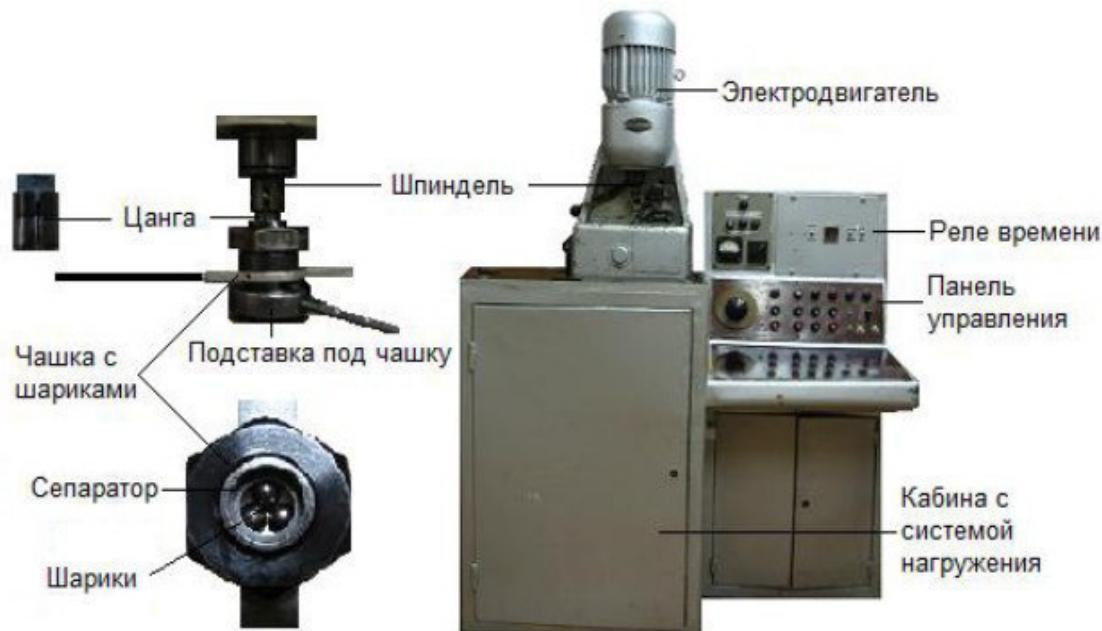
Рисунок 1. Внешний вид четырёхшариковой машины трения ЧШМ-3,2
