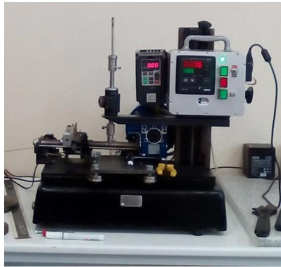
Рисунок 1. Машина трения возвратно-поступательного типа МТВП
