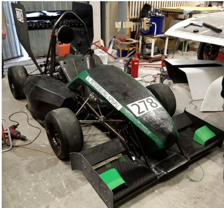
Рисунок 3. Общий вид аэродинамических элементов болида
