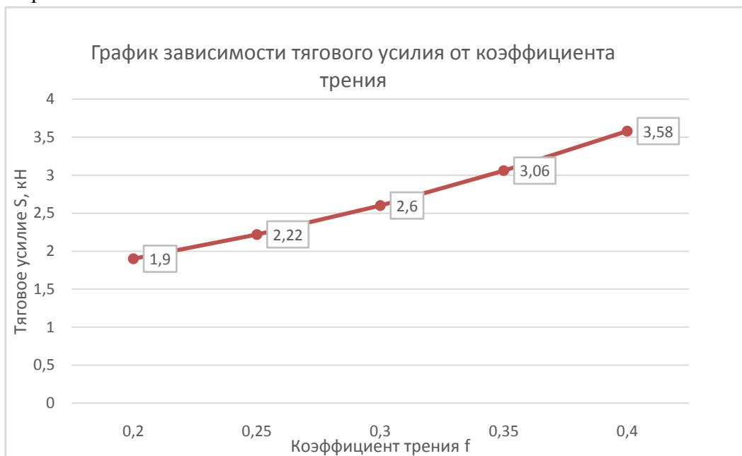
Рисунок 2. График зависимости тягового усилия от коэффициента трения барабана о ленту
