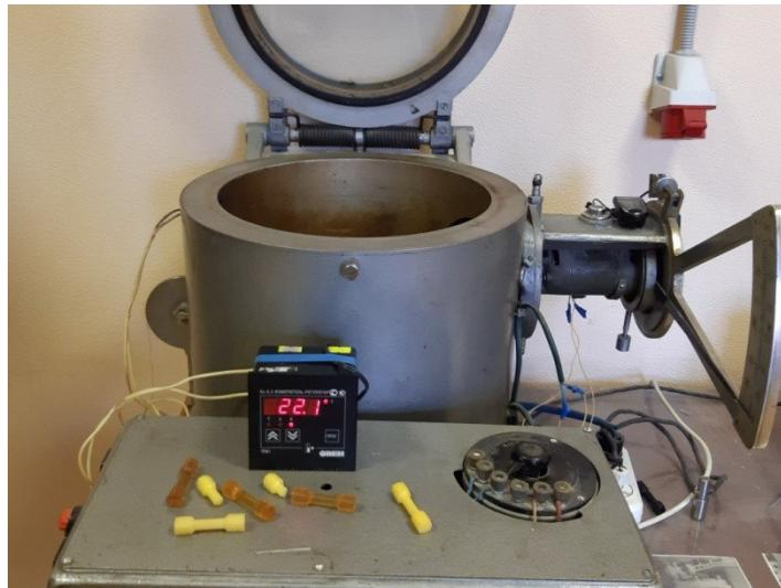
Рисунок 1. Установка для исследования динамического модуля и модуля внутреннего трения при знакопеременном изгибе с вращением
