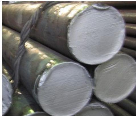
Рисунок 1. Горячекатаные заготовки из стали 18ХГ
