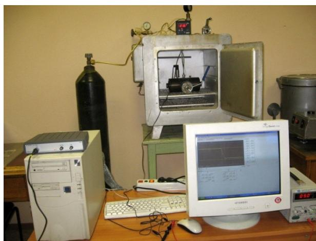
Рисунок 2. Стенд для испытаний материалов на устойчивость к взрывной декомпрессии
