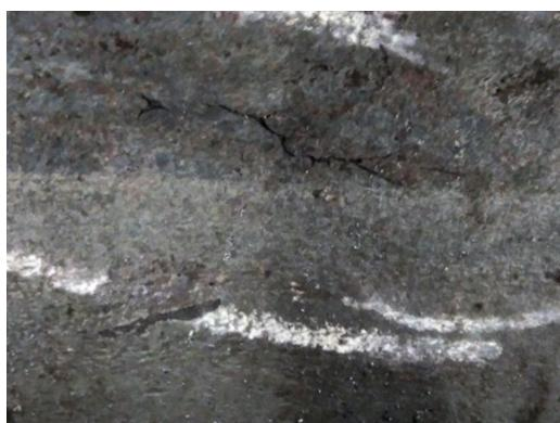
Рисунок 2. Поверхность круглого горячекатаного проката диаметром 135 мм с дефектом в виде трещин
