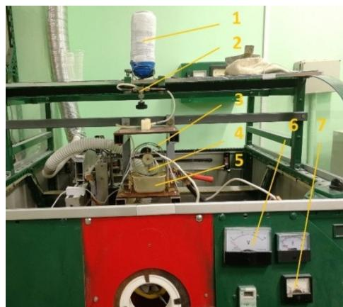
Рисунок 1. Устройство установки: 1 – емкость для электролита; 2 – клапан, регулирующий подачу электролита; 3 – обрабатываемый контур из нержавеющей стали; 4 – трубка, из подачи электролита; 5 – емкость, в которую стекает электролит; 6 – вольтметр; 7 – амперметр
