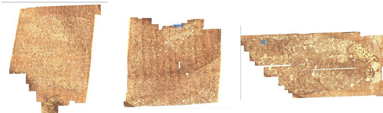
Рисунок 4. Виды разрушений образца при нагрузках 10,20 и 30 Н
