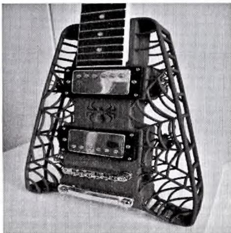
Рис. 3. Музыкальный инструмент из алюмид-наполненного полиамида профессора Diegel (Massey University, Auckland, New Zealand)
