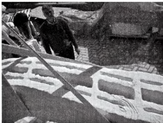
Рис. 4. Принтер итальянского инженера Enrico Dini для «печати» фрагментов зданий (технология Inkjet). Строительный материал – песок и неорганическое связующее
