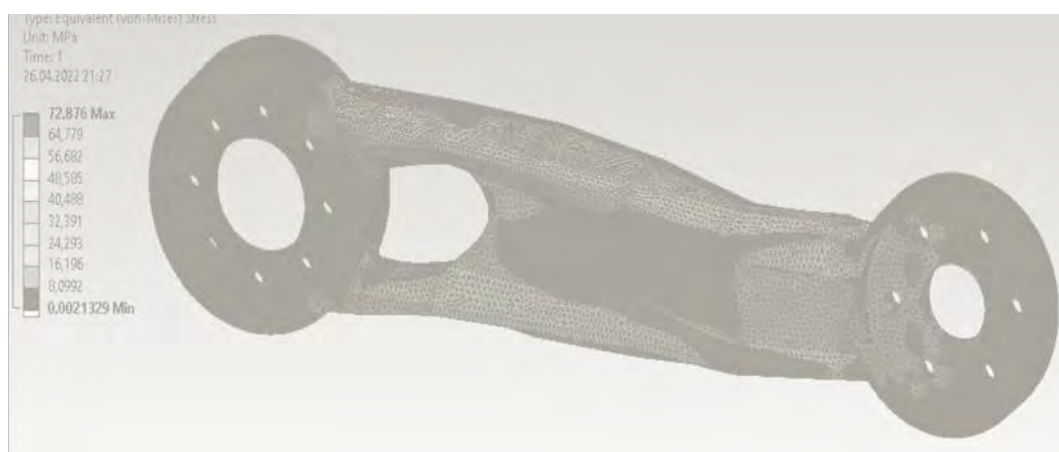
Рисунок 5 – Расчет эквивалентных напряжений, выполненный в САЕ комплексе ANSYS для топологически оптимизированной детали (грубая геометрия)
