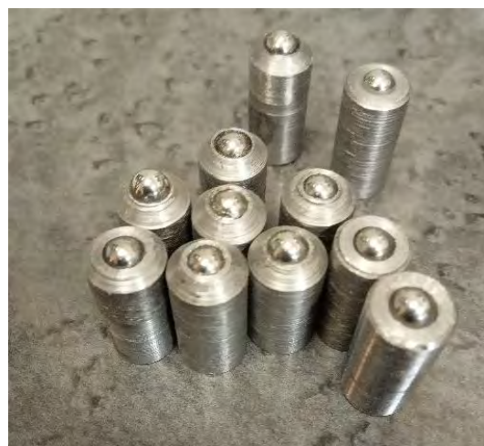
Рисунок 2 – Схема трения «шарик – плоскость»: а) «эллипс» пятна износа на инденторе; б) внешний вид инденторов
