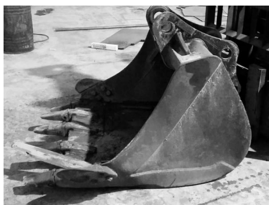
Рисунок 1 – Зубья ковша экскаватора после выработки 35 тыс. м 3 песчано-щебёночного грунта
