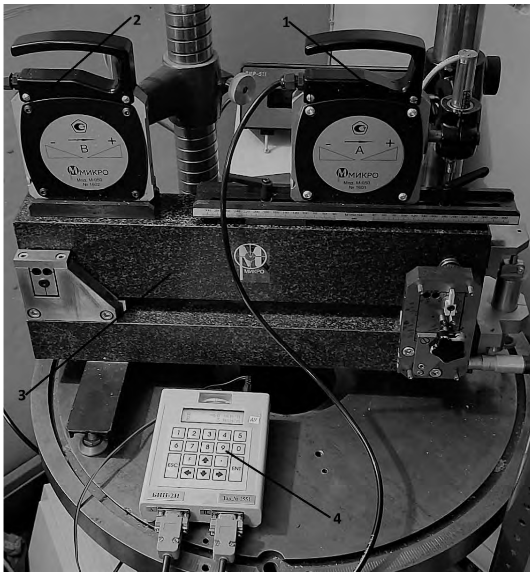
Рисунок 1 – Система электронных уровней М-050-03 для измерений отклонений от плоскости плит поверочных и разметочных: 1— уровень с измерительной кареткой; 2 уровень с подошвой; 3— экзаменатор 1-го разряда М-055; 4— электронный блок
