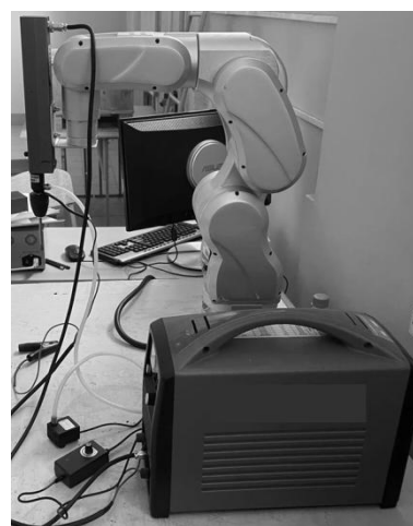
Рисунок 2 – Проект комплекса автоматизированного оборудования: а) кинематическая схема, где 1 - Основание; 2 - Первое плечо; 3 - Второе плечо; 4 - Третье плечо; 5 - Электроэрозионный патрон. б) прототип роботизированного комплекса
