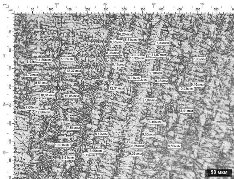
Рисунок 2 – Измерение междоусных промежутков образца сплава АК12 при увеличении \times 200 , отлитого в кокиль: 1 – центр; 2 – поверхность
