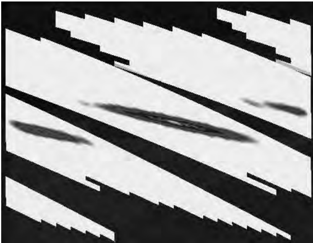
Рисунок 3 – Распределение контактного давления на 4 шаге зацепления
