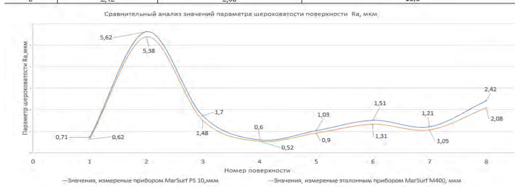
Рисунок 5 – График средних значений измерений и значений суммарной погрешности
