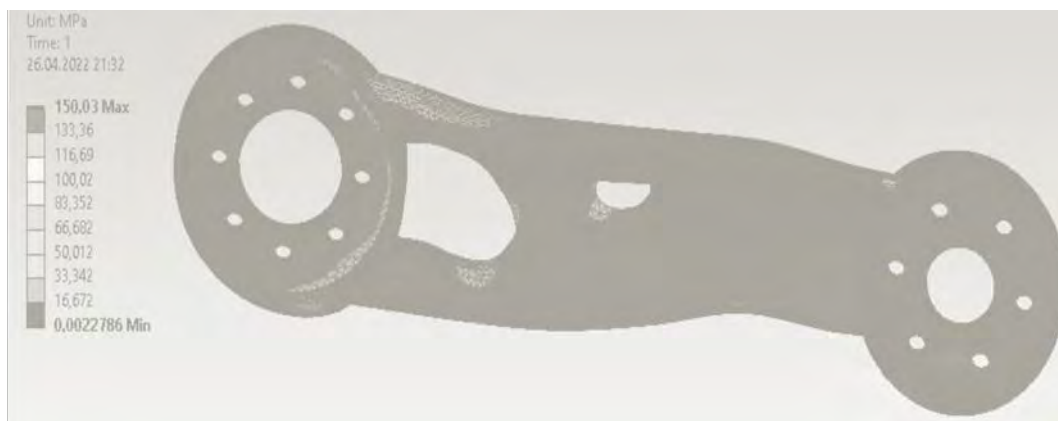
Рисунок 6 – Расчет эквивалентных напряжений, выполненный в САЕ комплексе ANSYS для штампуемой детали
