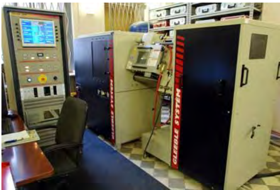
Рис. 2. Комплекс Gleeble-3800 с присоединенным модулем для растяжения и сжатия
