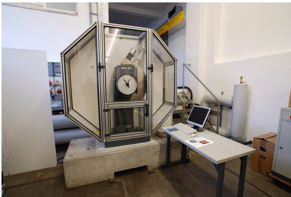
Рис. 15. Копер фирмы Zwick/Roell с энергией маятника 450 Дж
