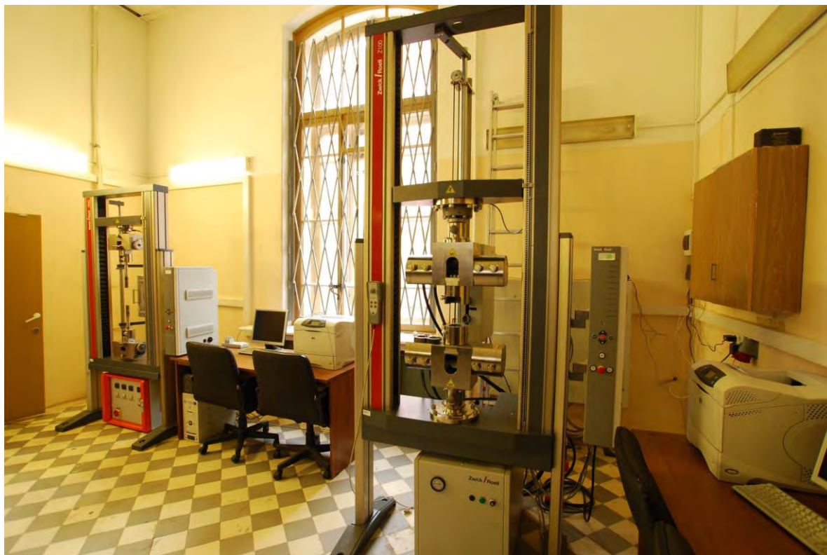
Рис. 14. Разрывные машины фирмы Zwick/Roell усилием 50кН и 100кН для проведения горячих и холодных испытаний металлов
