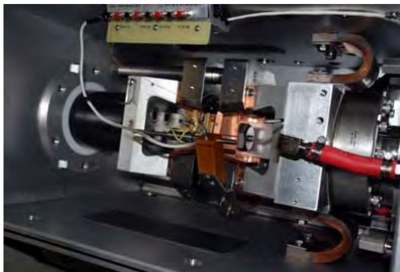
Рис. 6. Общий вид рабочей камеры для испытаний на растяжение и сжатие
