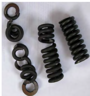
Рисунок 1 – Поломка пружины гидравлического замка на подъемнике
