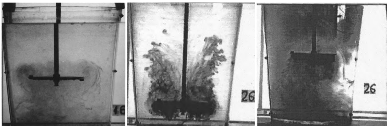
Рисунок 1 – Моделирование перемешивания жидкой фазы при помощи вихревого смесителя
