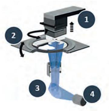
*Рис. 1.* Принципиальная схема LCM-технологии: 1) платформа построения; 2) ванна с суспензией; 3) оптическая система; 4) LED-проектор [1]
