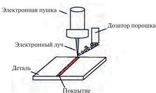
Рис. 1. Схема электронно-лучевой наплавки
