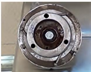
Рис. 2. Приспособление для закрепления образцов
