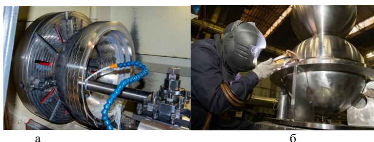
Рисунок 2 – Уравнильная цистерна: а - изготовление деталей уравнильной цистерны; б - сварка уравнильной цистерны
