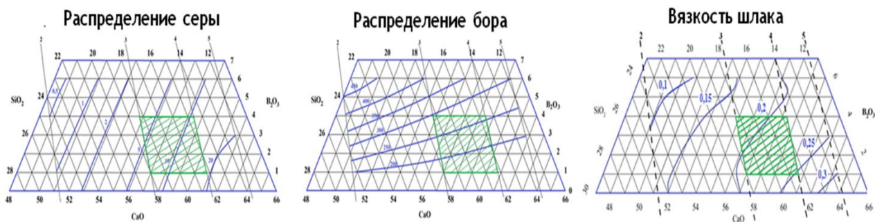
Рисунок – Диаграммы зависимости «состав - свойства» для распределения серы и бора между металлом и шлаком, и вязкости шлака от его состава
