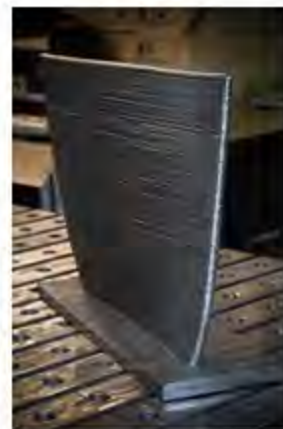
3D печать по технологии СПБУ Производственный цикл для ед. продукции – ~26 часов, партия от 1 шт.
