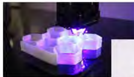
Процесс печати сотовой структуры с использованием УФ света
