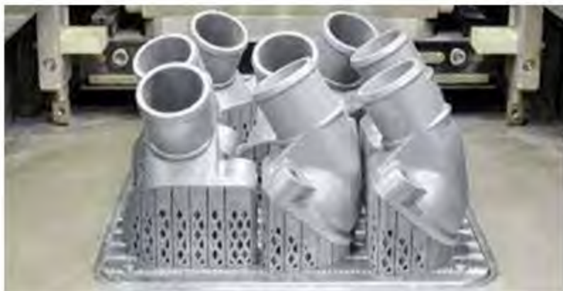
Изготовление большого количества деталей за одну печать
