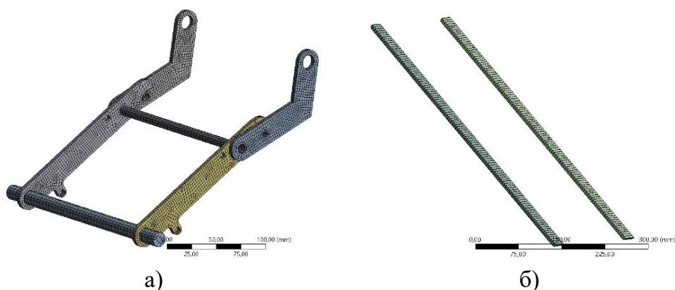
Рисунок 6 – а) Конечно-элементная сетка для механизма, б) конечно-элементная сетка для направляющих
