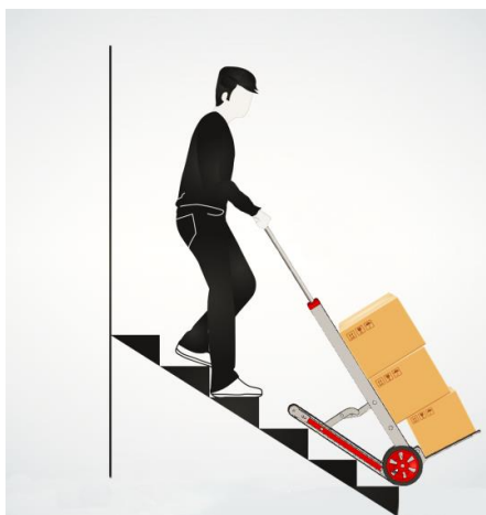
Рисунок 11 – Схематичное представление работы тележки на лестнице
