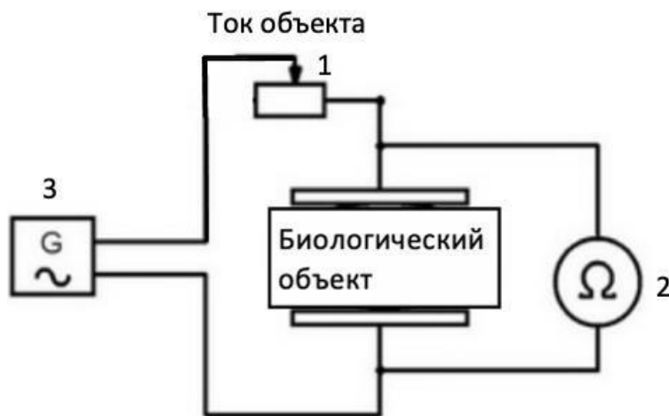
Рисунок 1 – Принципиальная блок-схема опыта для измерения импеданса биологической жидкости
